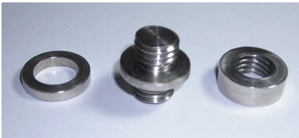
Figura 7.7 - Elementos de fixação do disco piezelétrico.
