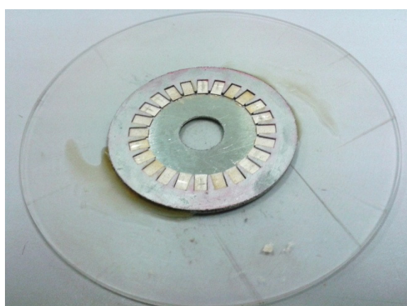
Figura 7.3 - Posicionamento das cerâmicas com auxílio de gabarito.
